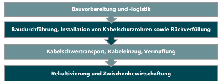
Ablaufschema für den Bauablauf
